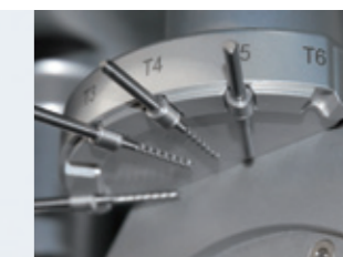
Prise, changement, contrôle et calibration automatiques de l'outil.
